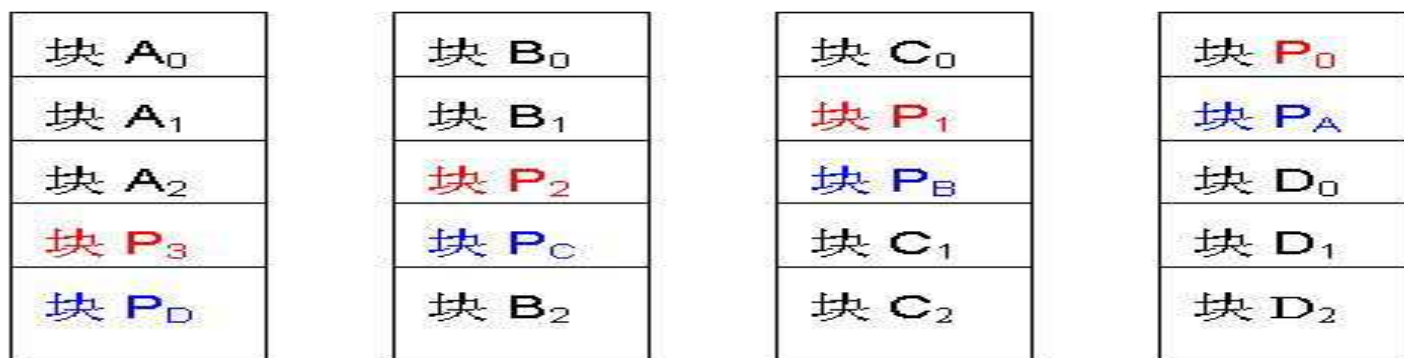
RAID 6 级双维块交叉奇偶校验独立存取盘阵列示意图
